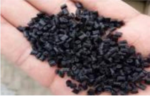
자동차, 전자&전기, 가구 및 포장에 이르는 분야에서 전 세계적으로 사용하는 고성능 폴리아미드6 및 폴리아미드66 소재 제품군입니다.
